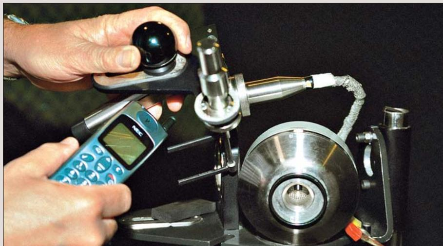
Para la prueba de calidad de sonido, se graba la señal del altavoz del teléfono mediante un aparato muy sensible, denominado "oído artificial", que simula al oído humano.
