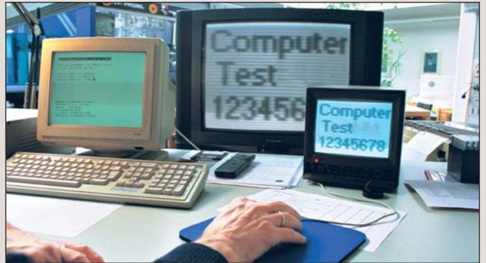
El monitor de la izquierda controla las acciones del robot de las pruebas, las otras dos pantallas muestran lo que ve la cámara.
