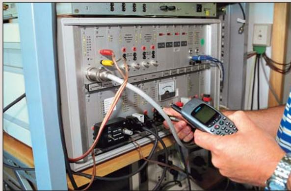
Con el aparato que se ve en la fotografía se comprueba si el teléfono alcanza la potencia de emisión requerida.
