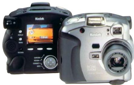
La cámara DC-290 utiliza una conexión USB para pasar las fotos al ordenador y una salida de vídeo para verlas en la tele.
