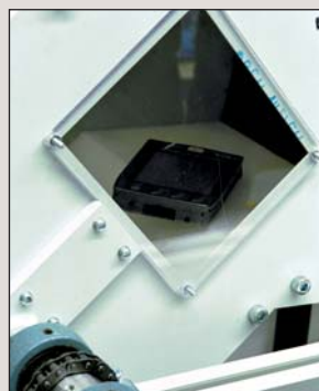
En el tambor de caída los PDAs caen unas 100 veces sobre una placa de acero.
