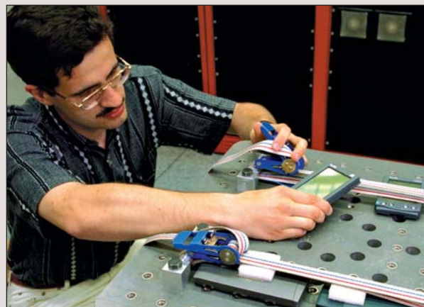
En la mesa oscilante se simula el ajeteo diario que sufre un PDA (arriba). Un robot comprueba las funciones de los organizadores después del test de líquidos (derecha).
