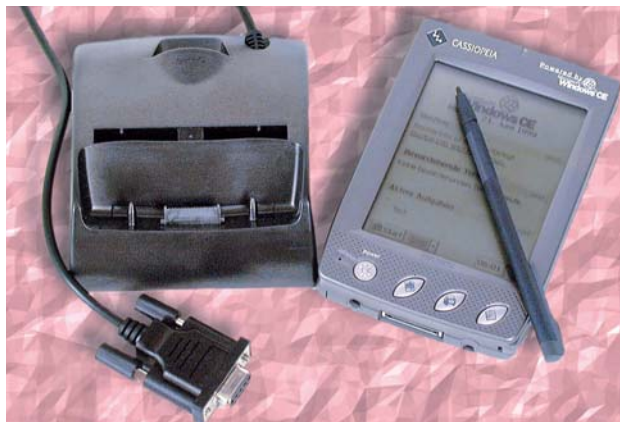
El módulo de color negro de la izquierda es la "Docking-Station", que sirve para conectar el organizador al PC.
