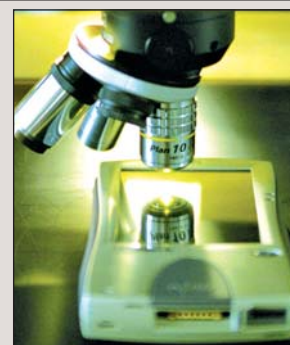
Con este aparato especial el técnico del laboratorio comprueba la calidad de la pantalla. La cámara tiene una precisión de milésimas de milímetro.
