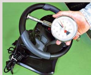
Esta prueba sirve para medir la sujeción del volante.
