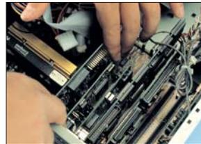
Luego colocaremos un tornillo para fijar perfectamente la tarjeta.
