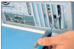
**3** El siguiente paso es colocar la tarjeta en la ranura. Tenga cuidado de no tocar los contactos dorados de la tarjeta, ya que podemos estropear algún componente. Para insertarla de forma correcta tendremos que colocarla verticalmente sobre la ranura de expansión.
