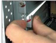
**14** Coloque la tarjeta exactamente en posición vertical y enchúfela con cuidado en el lugar de conexión presionando suavemente.
