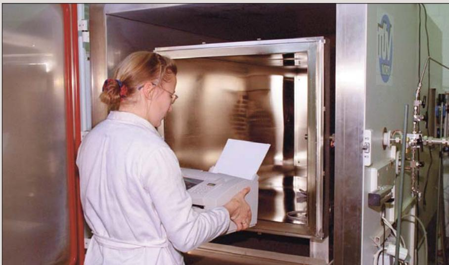
**Para medir la contaminación dejamos funcionar a los aparatos dentro de una cámara aislada y así, en todos, se hace la simulación con los mismos valores de temperatura y de humedad.**
