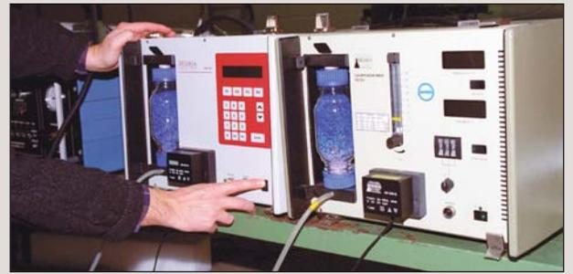
**Para el análisis sobre la presencia de productos nocivos se toman en la cámara de medición muestras de aire que se filtran y que se secan.**
