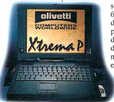
incluye una disquetera de 3,5 pulgadas y una unidad CD-ROM a 24x. Su pantalla TFT de 12,1 pulgadas **SVGA** **10 (Pág.6)** tiene una resolución de 800 x 600 con 64.000 colores. La tarjeta de sonido que integra, compatible con Sound Blaster de 16 bits, junto con los dos altavoces estéreo y el micrófono que incorpora este portátil, ofrecen al
