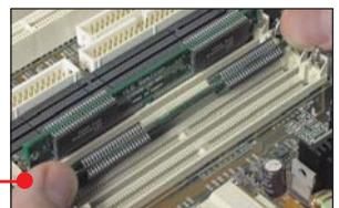
**4** Si tiene que instalar módulos de memoria DIMM, entonces hay que insertar los módulos de memoria perpendicularmente a la placa base y a continuación debe fijar las dos pestañas al módulo de memoria.
