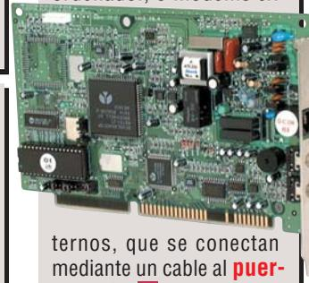
ternos, que se conectan mediante un cable al **puerto serie** **12** del sistema. Los más rápidos pueden llegar a 56.000 bps (bits por segundo) de transferencia de datos. Con el módem es posible conectarse a Internet o enviar y recibir faxes.
