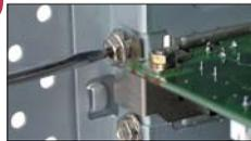
**16** Desenchufe el conector de monitor de la tarjeta gráfica y conéctelo a la salida de vídeo de la tarjeta.
