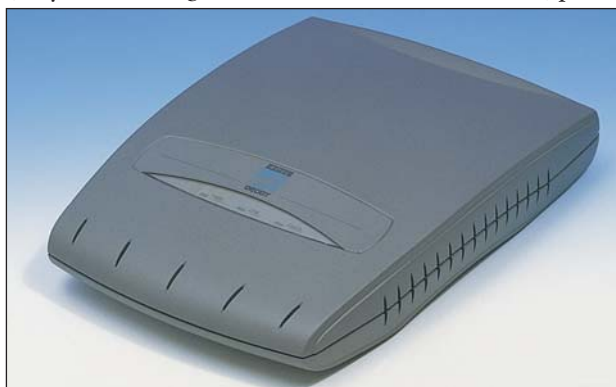
Prototipo de un módem ADSL de Orckit; su aspecto externo no se diferencia esencialmente del modelo actual
