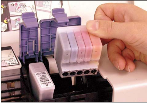
En algunos casos las cargas de tinta y los inyectores se cambian por separado, como en las impresoras de Epson.
