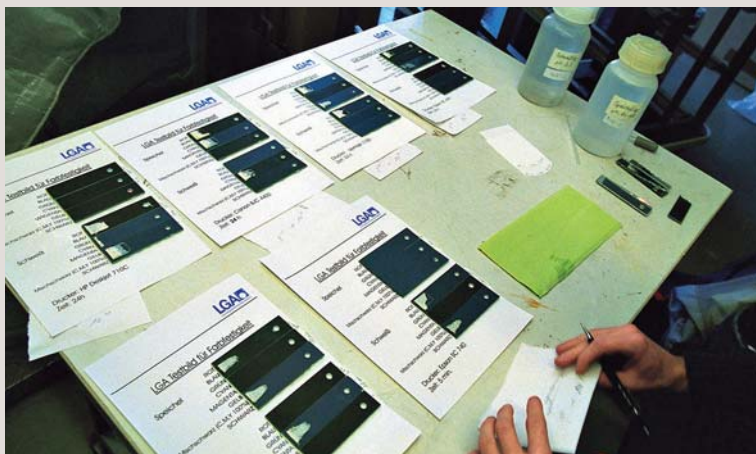
En el laboratorio de LGA "torturamos" cada hoja impresa a conciencia. Medimos la resistencia del documento con saliva y sudor artificiales.
