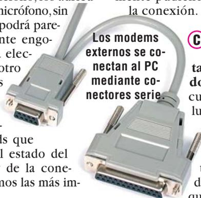
Los modems externos se conectan al PC mediante conectores serie.
