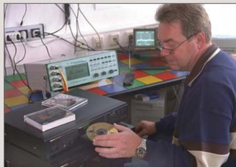
Para conocer el comportamiento de cada grabador de CDs se empleó un sistema de medición de alta precisión que localiza la distorsión que genera cada uno.
